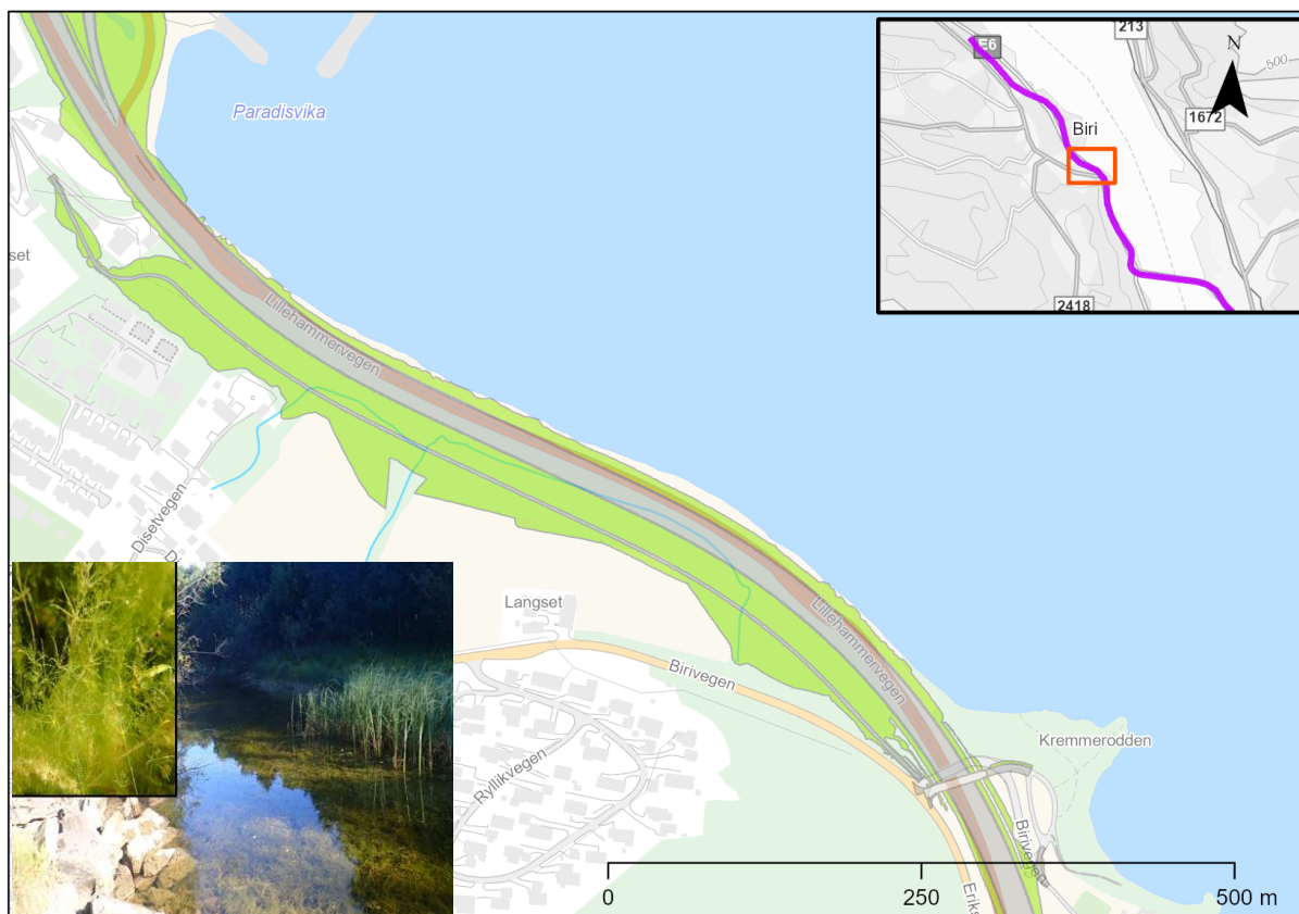
Figur 4-19. Bekk ved Langset blir fylt igjen. Veifylling er vist i grønt. Kilde COWI AS
