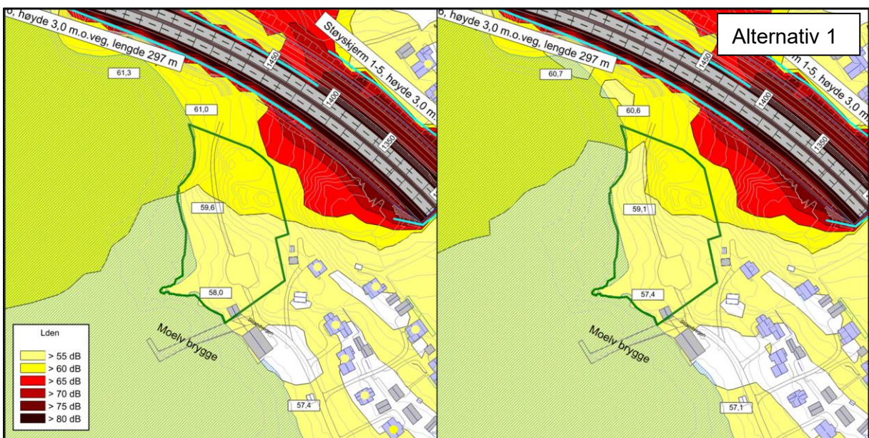
Figur 19 Støyberegninger for strandsonen ved Moelv brygge, nordre alternativ, med planforslaget (t.v.) og løsning med lav (1,0 m) skjerm på brua (t.h.).
