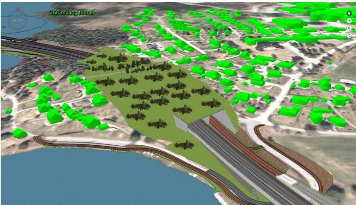
Figur 2: Illustrasjon viser 260 meter kulvert i Moelv. 260 meter er vurdert som teoretisk lengste kulvert i Moelv, uten å være i konflikt med eksisterende eller planlagt infrastruktur. Kilde: COWI
