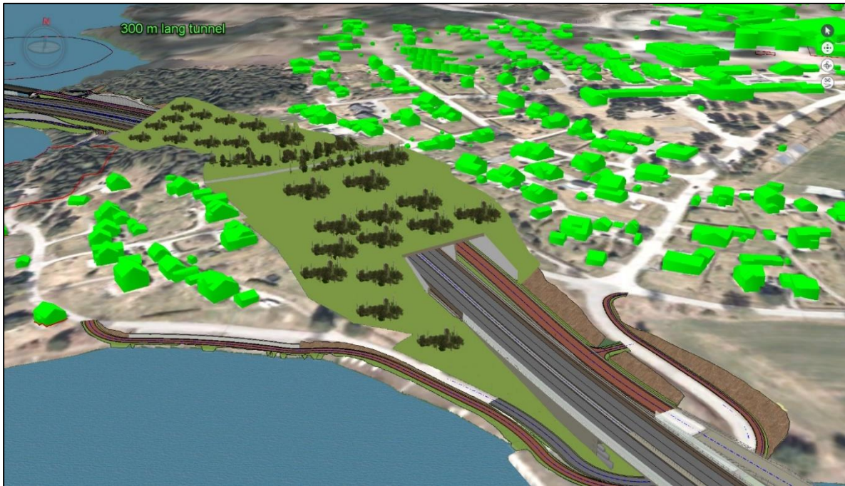
Figur 1 Illustrasjon viser en 300 meter lang kulvert i Moelv. En slik løsning som illustrert over vil være til hinder for mulige adkomstløsninger til nytt sykehus i Moskogen. Kilde: COWI
